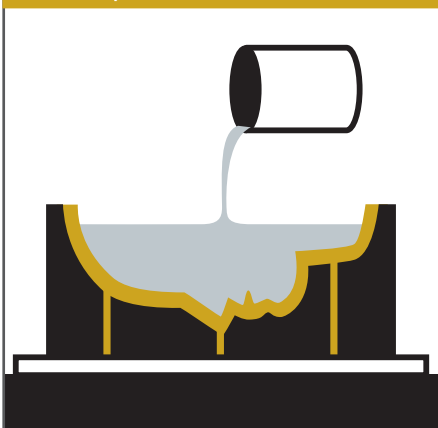
1a Colada de un molde de película de una pieza
